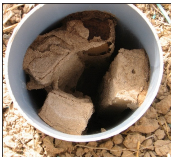
تصویر ۴. آسیب موربانه به چوب گردو (عکس از: نگارنده).
