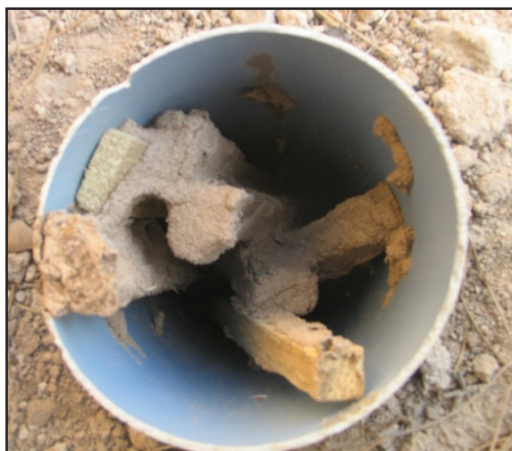
تصویر ۲. حمله موربانه به چوب زبان گنجشک. (عکس از: نگارنده).
